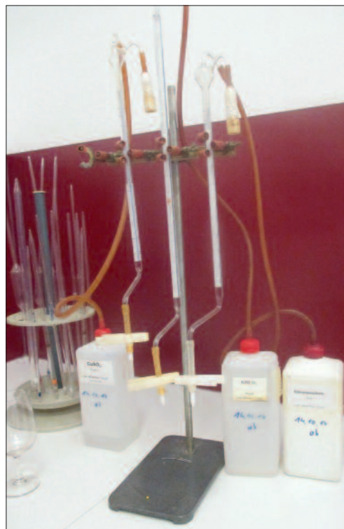
Werden die Versuchslösungen an Büretten angeschlossen, erleichtert man sich damit häufiges Arbeiten. Foto: Schneider
